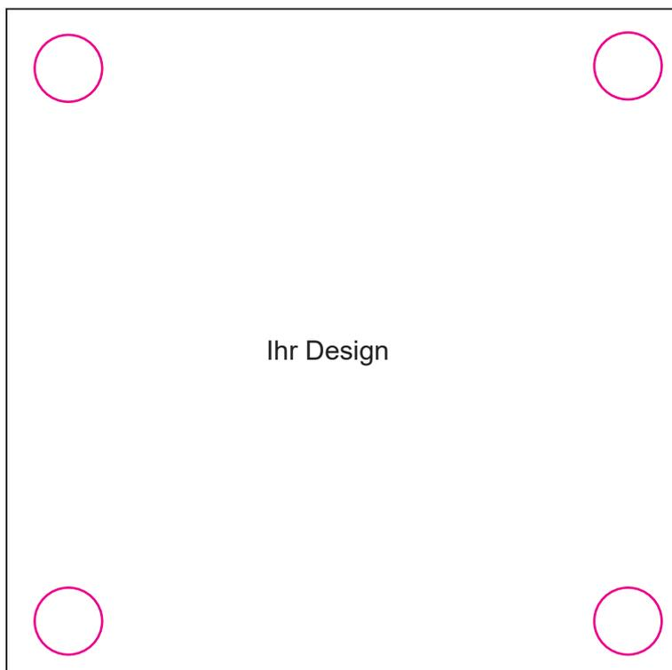
Beispiel mit 4 Bohrlocher von 10 mm
